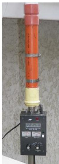
eventualmente instala antenas VHF y UHF, de ser posible **compruebe los cables patrones con instrumento analizador** ( Procedimiento indicado en manual del MFJ259, " Testeo y sintonizado de adaptadores y líneas de transmisión ", desde 1.8 hasta 170 MHz ). Si cuenta con instrumento analizador, puede conectarlo directamente instalado en la antena.
