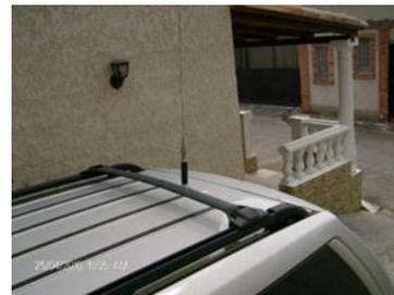
**Para antenas fijas VHF y UHF, antes de realizar el montaje**, sugiero ajustar dicha antena empleando un cable patrón ( Línea eléctricamente corta y aproximadamente terminada en Nodo ) y al culminar los ajustes es conveniente conectar el cable definitivo para volver a chequear las mediciones. Si
