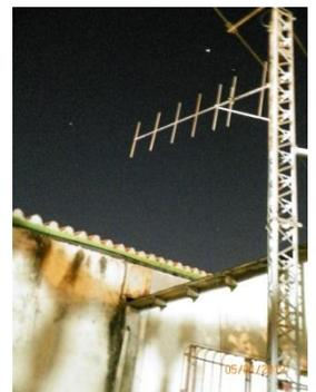
la mínima ROE se mantiene constante pero la resonancia se observa trasladada hacia otra frecuencia, **Iniciando en 144.45 MHz, 1er. recorte en 144.88 MHz, 2do. recorte en 145.37 MHz, 3er. recorte 145,99 MHz y último recorte finalizando en 146.610 MHz.** Igualmente **observe como mejora el ancho de banda en la medida que aproximamos a la frecuencia de resonancia original de la antena = 146.8 MHz ):**
